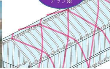
妻面が奥行き方向に倒れるのを防ぎます。筋交い直管は各アーチパイプと部品で固定し、直管の端は地面に30cm以上埋め込みます。ハウス全体の耐力が約20%アップします(※)。
