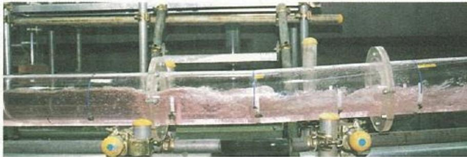
写真-2 跳水の発生状況 (case-5E5)
