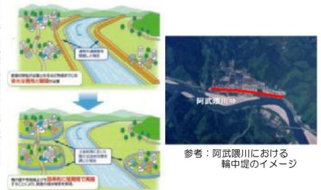
図-1.149 河道改修＋輪中堤による対策の概要
