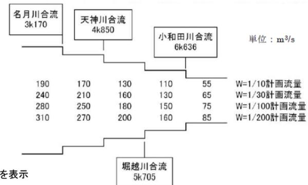
図-1.42 田尻川 流出計算結果
