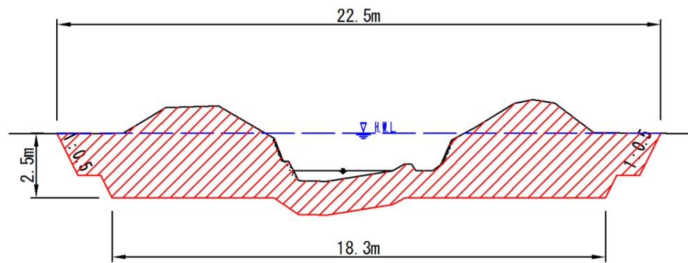
図-2.13 ①整備断面例(4.10km 付近)
