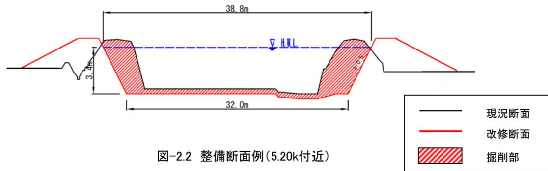
図-2.2 整備断面例(5.20k付近)
