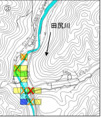
図-3.4 (15) 田尻川 洪水リスク表示図
