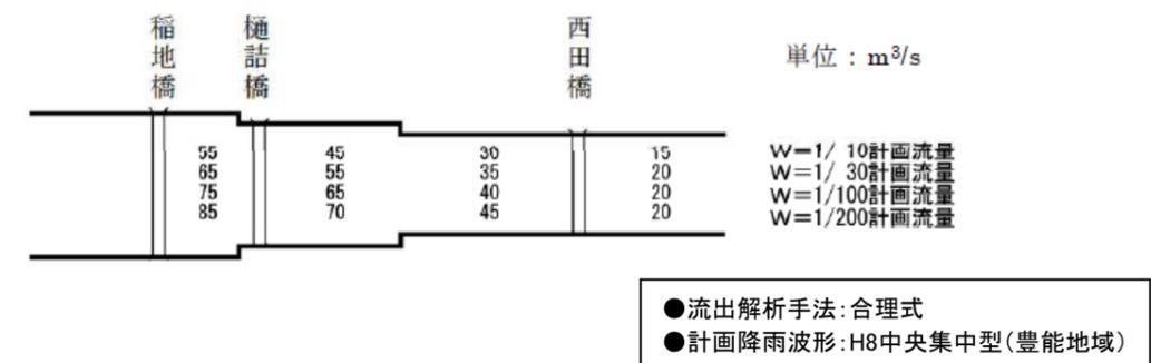
図-1.40 長谷川 流出計算結果
