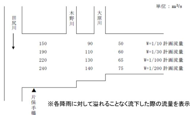
図-1.43 野間川 流出計算結果
