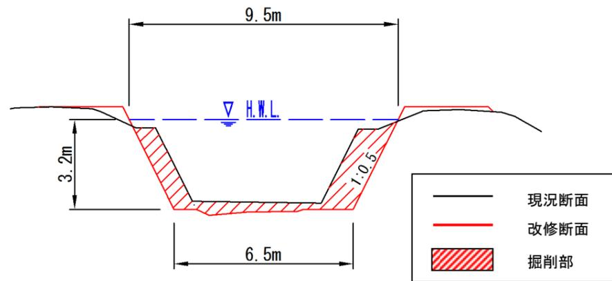
図-2.7整備断面例(0.10km付近)
