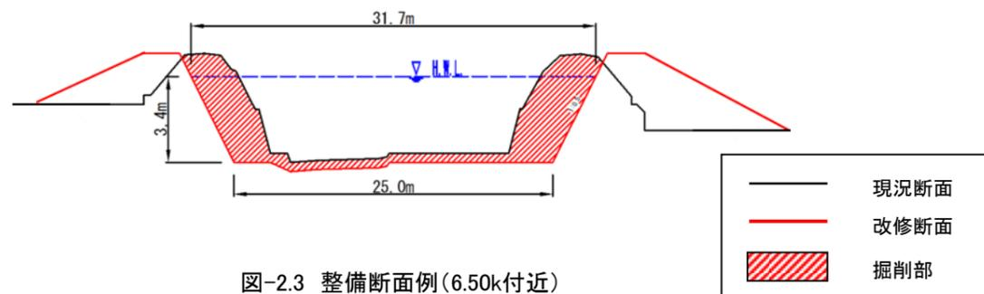
図-2.3 整備断面例(6.50k付近)
