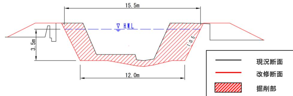
図-2.5 整備断面例(2.70km 付近)
