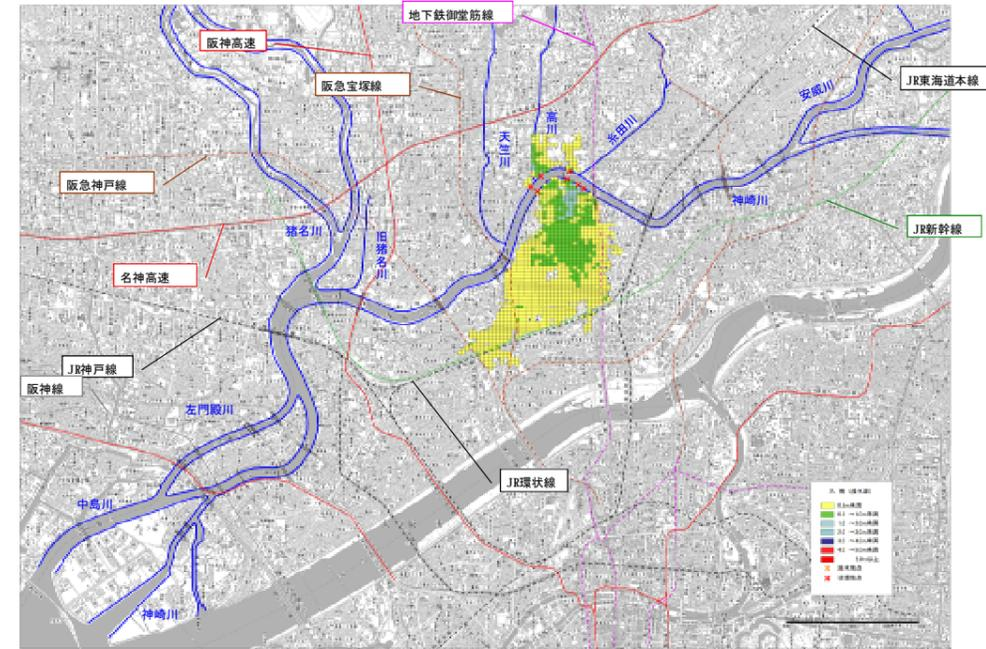
時間雨量 60 ミリ程度 (1/40) の降雨の浸水状況
