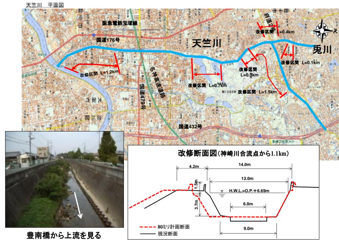
案①-2 河道改修(河床掘削)
