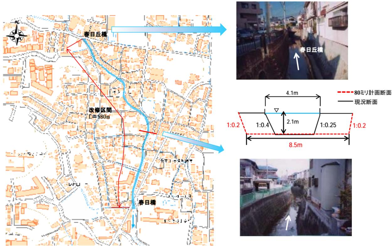
案①-2 河道改修(河床掘削)
