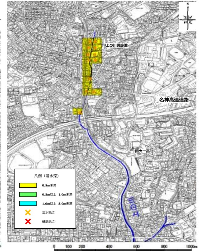
※被害最大となる破堤地点での破堤を想定（1洪水）
