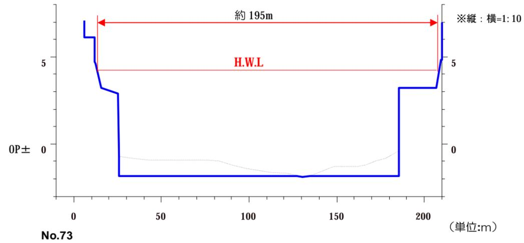
図 神崎川河床掘削横断面図（猪名川合流点付近）
