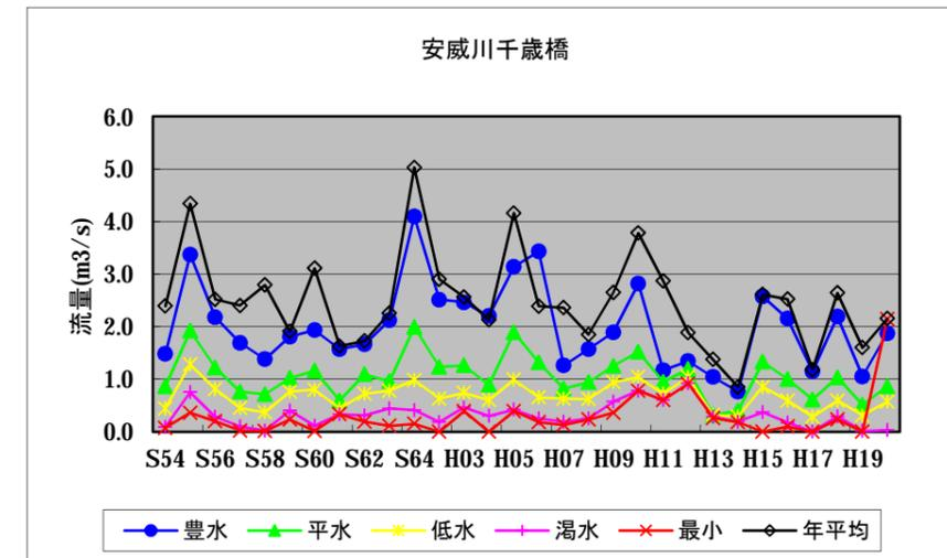
豊水流量・平水流量・低水流量・渇水流況は、一年を通じての日流量を大きい方から小さい順に並び替えて算出し、それぞれ次のように示している。
