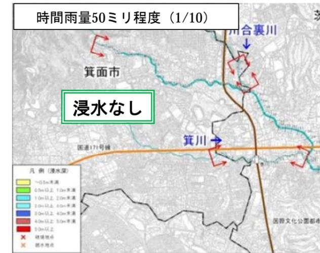
※被害最大となる破堤地点での破堤を想定（1洪水）
