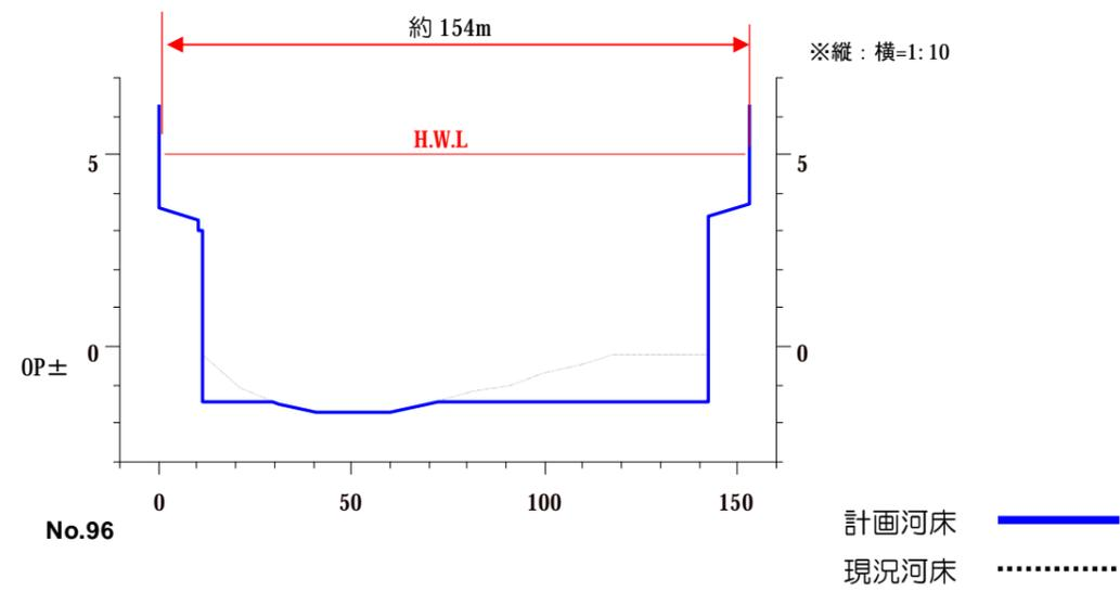
図 神崎川河床掘削横断面図（<sup>かみす</sup>神洲橋～三国橋）
