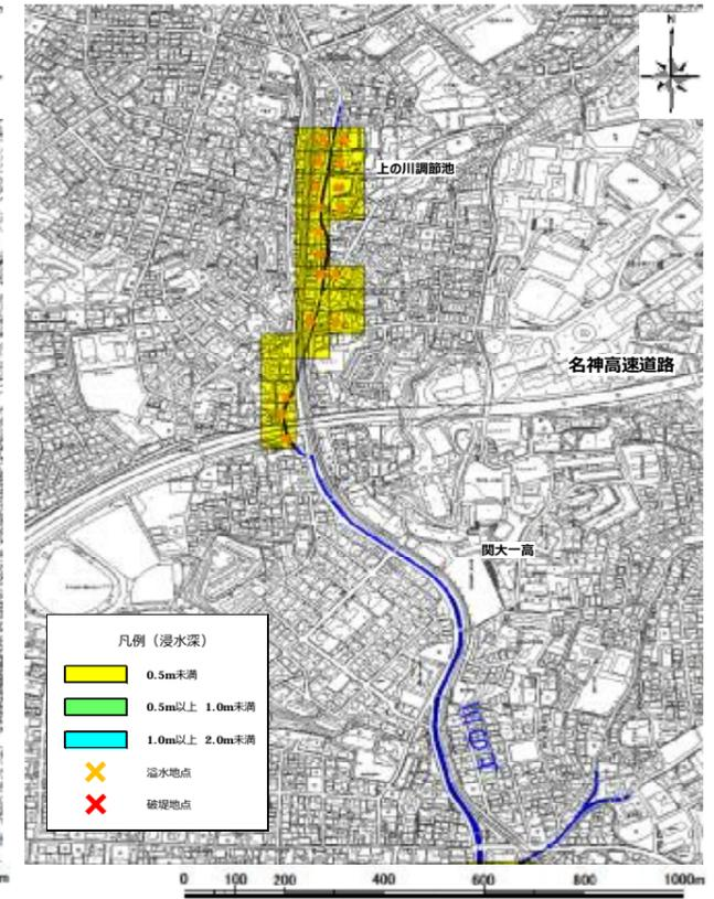
※被害最大となる破堤地点での破堤を想定（1洪水）
