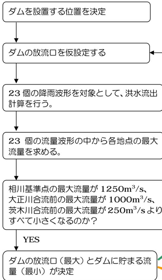
ダム下流の流量が神崎川の掘削を考慮した流下能力以下になり、ダムの容量がなるべく小さくなるような放流口の大きさを探す。
