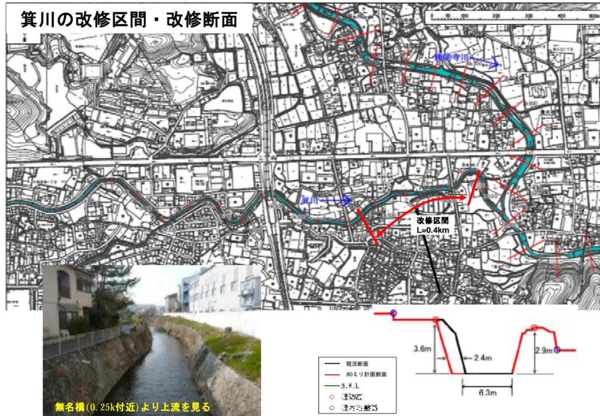
案①-2 河道改修(河床掘削)
