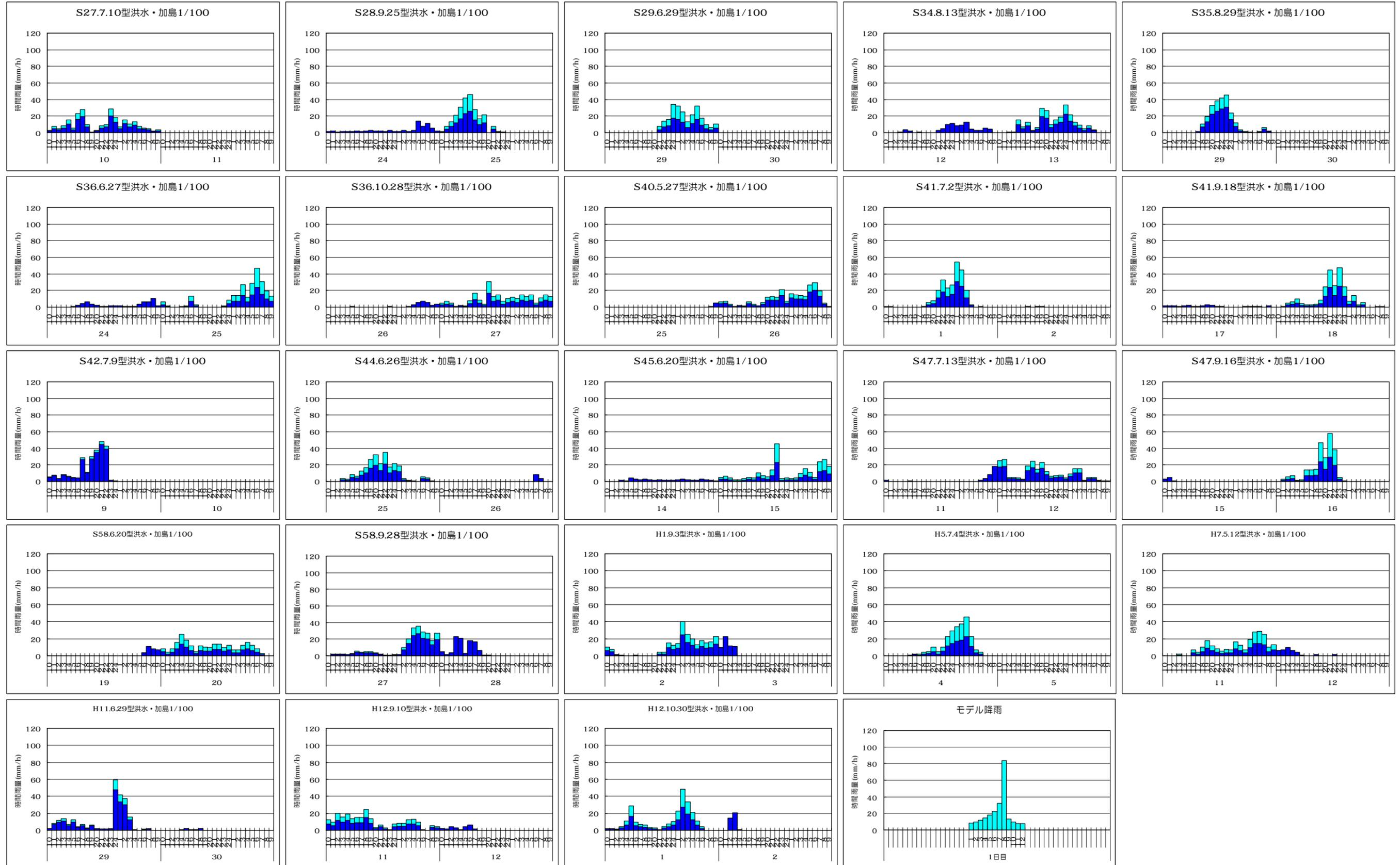
○ 23の降雨波形（相川：実績22降雨の引き伸ばし+モデル降雨）
