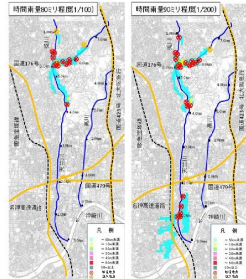
※被害最大となる破堤地点での破堤を想定（1洪水）
