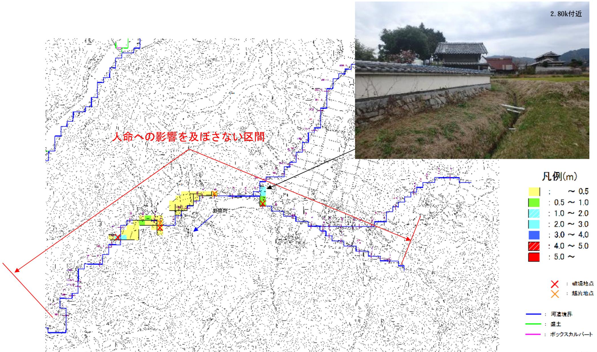
※想定される全ての破堤・越水による浸水を重ね合わせて最大浸水深を表示
