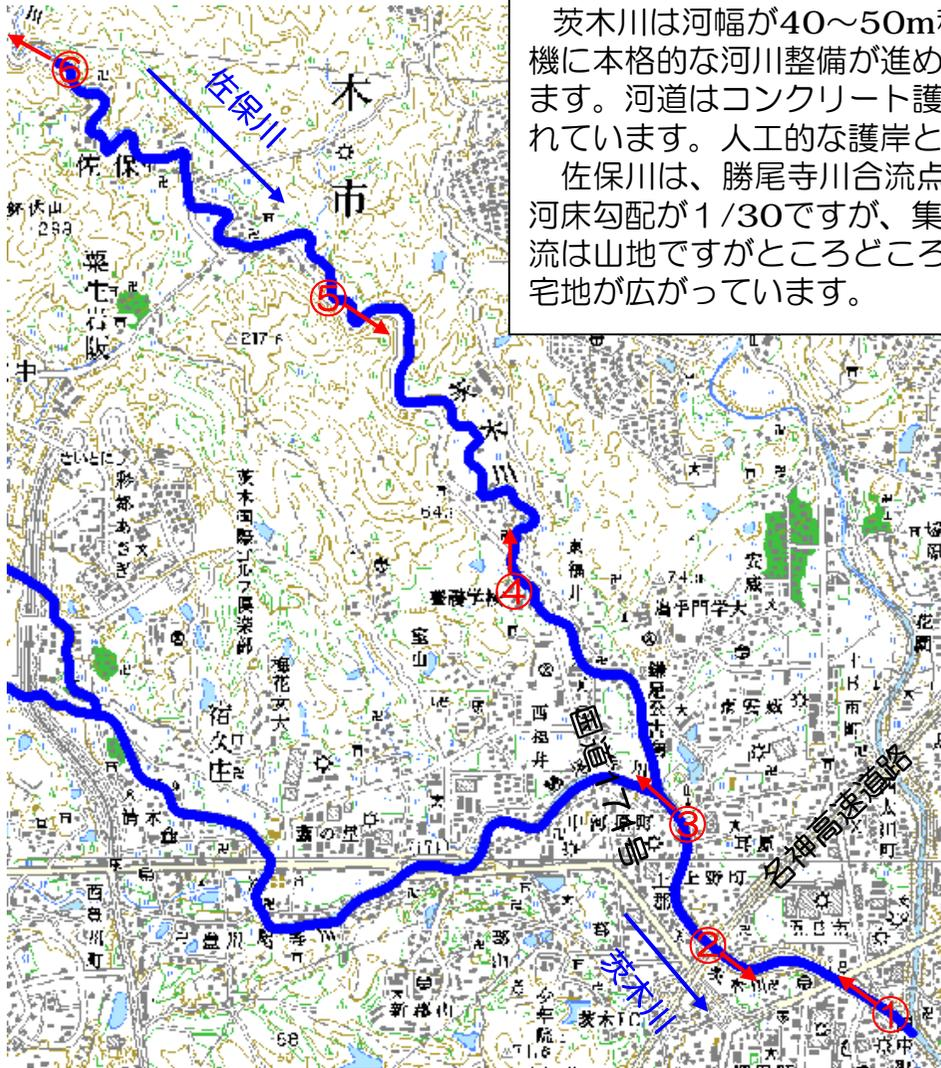
茨木川は河幅が40～50m程度、河床勾配が1/350程度となっています。昭和42年の北摂豪雨を契機に本格的な河川整備が進められ、安威川合流点から勝尾寺川合流点までの区間が改修済みとなっています。河道はコンクリート護岸で整備されており、堤防には階段護岸、高水敷には遊歩道などが整備されています。人工的な護岸となっていますが、寄り州が発達してヨシ、クサヨシ等が生育しています。
