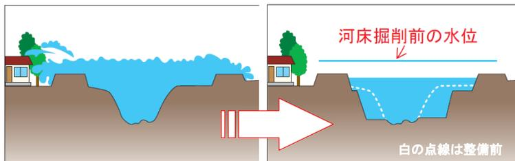
川を広げたり、深くすることによって、目標とする概ね50mm/hの降雨により発生する洪水が安全に流れる断面を確保します。
