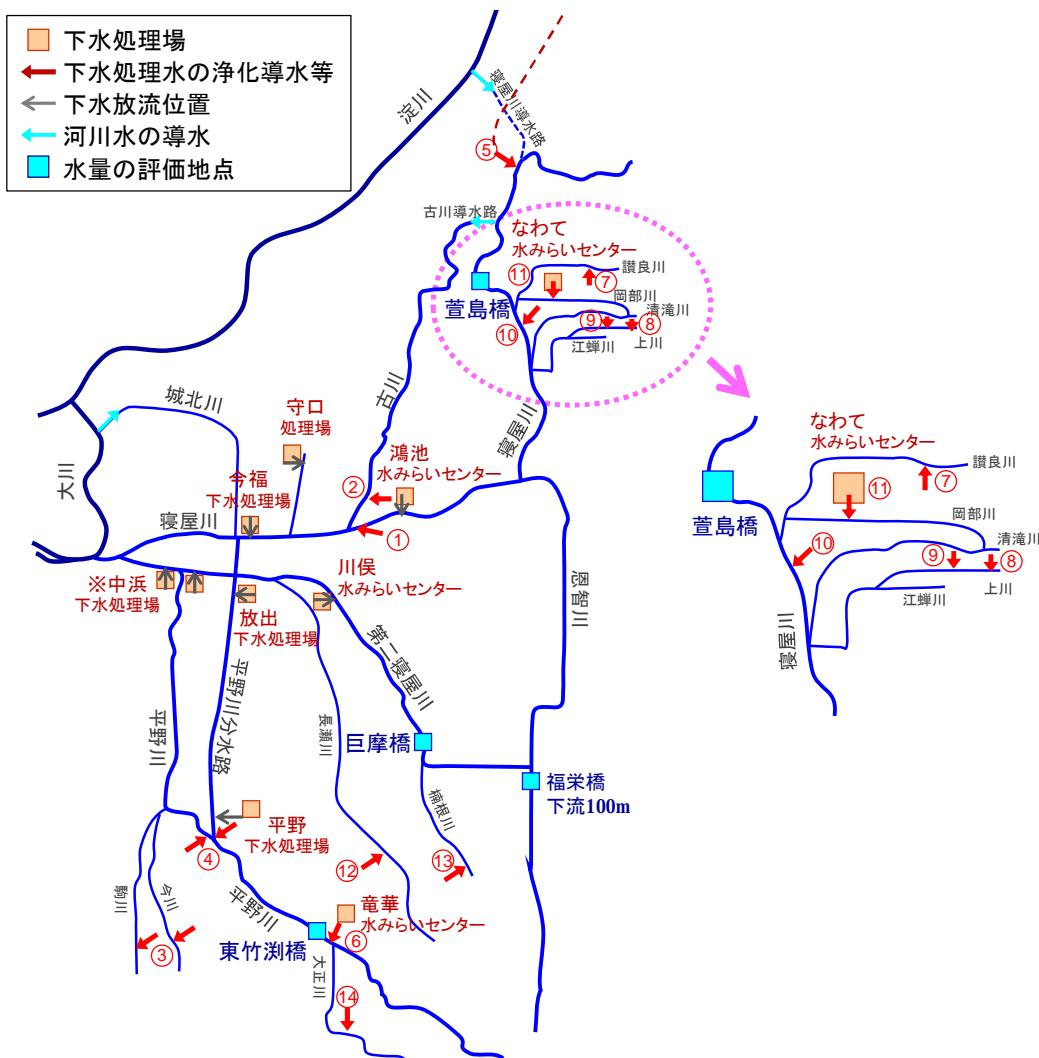
図 5.12 下水処理水の導水位置
