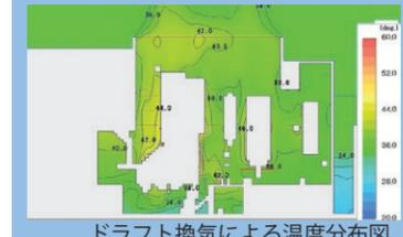
ドラフト換気による温度分布図
