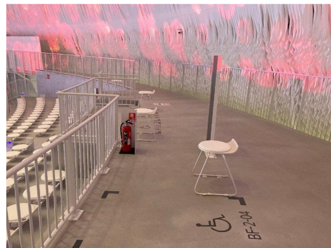
前席との高低差によりサイトラインを確保した例(シャインハット)
