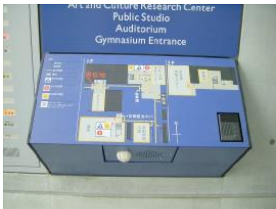
☆○図 13.2 触知図案内板の例
