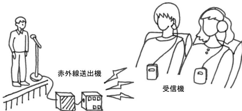
※赤外線補聴装置とは、対象エリアに赤外線送出機を設置し、受信機で受信する。広いエリアの場合は、3種類（10m、30m、45m）の送出機を単独又は組み合わせて配置する。ヘッドホン又は補聴器で受信する。
