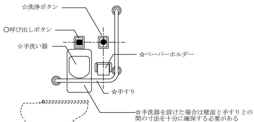
●☆図 8.13 操作が容易な洗浄装置
