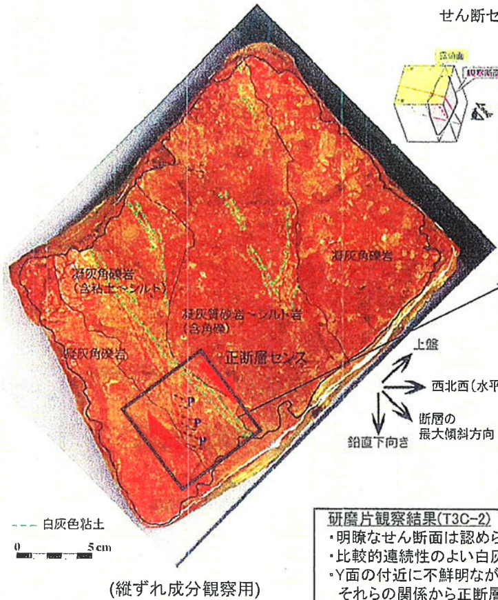
T3C-2 研磨片 〔白灰色粘土を挟む箇所〕
