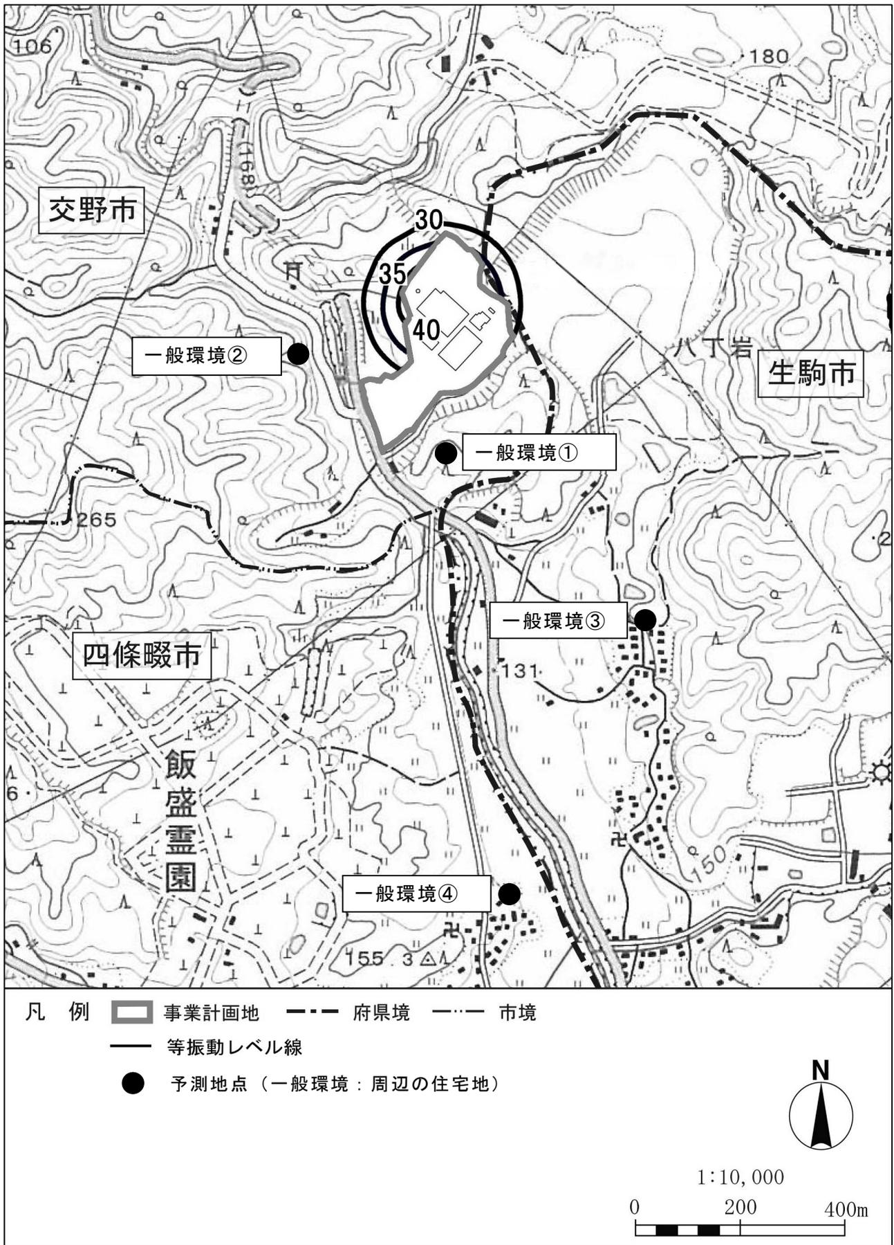
図 7-5-2.5(2) 施設の稼働に伴う施設振動の予測結果（一般環境  $L_{10}$ ）
