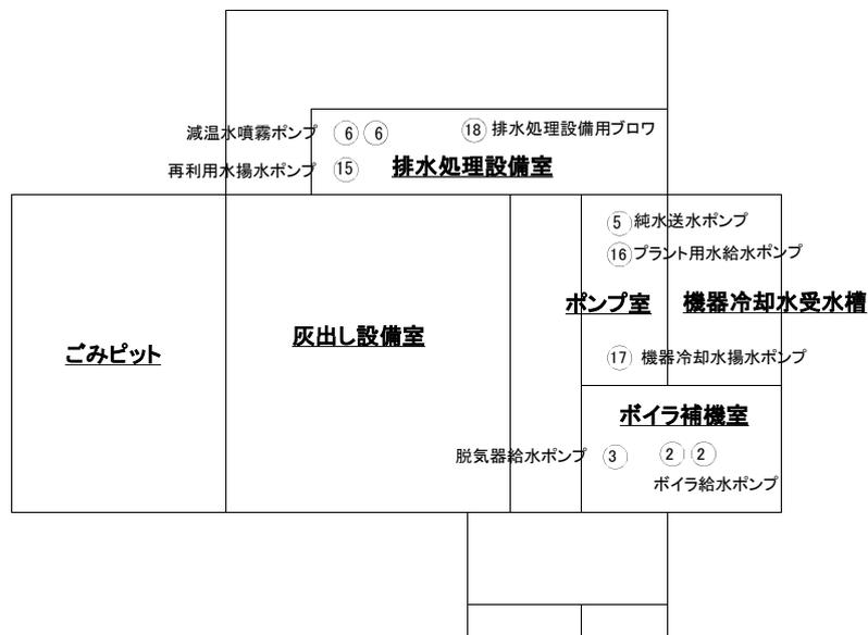
図 7-5-2.3 (1) 振動発生機器の配置 (熱回収施設 B3F)
