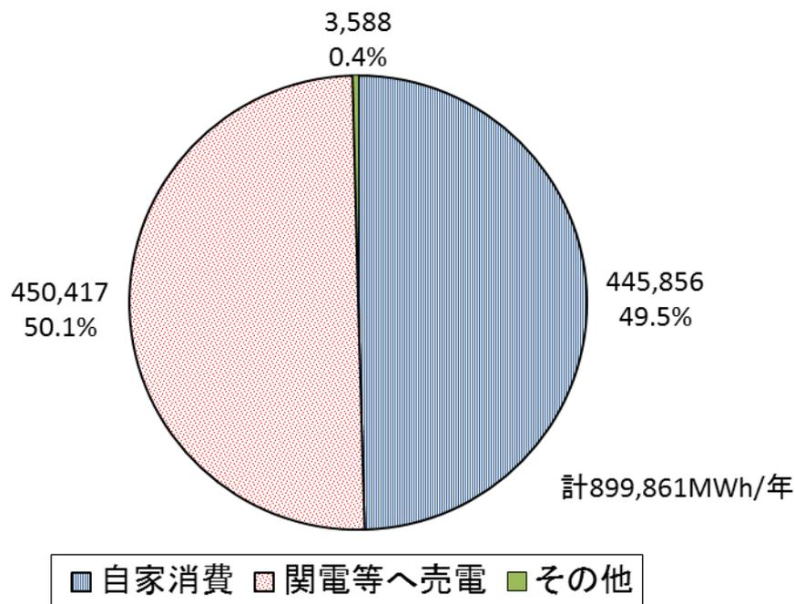
図2-4 ごみ焼却余熱による発電利用状況
