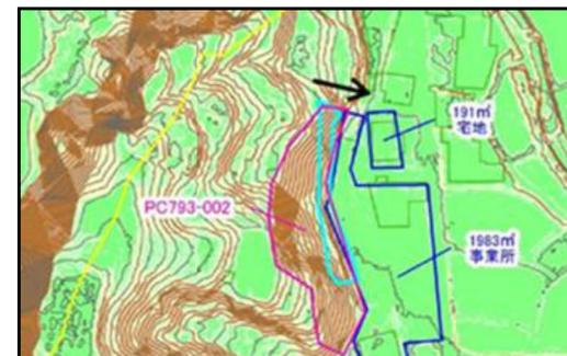
高精度な地形情報（航空レーザー測量）による抽出
