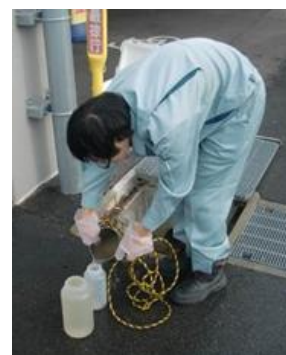
事業所排水の採水検査
