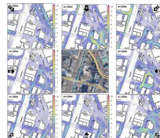
ビル風シミュレーション画像の例（出典：ウェザーニューズ社）
