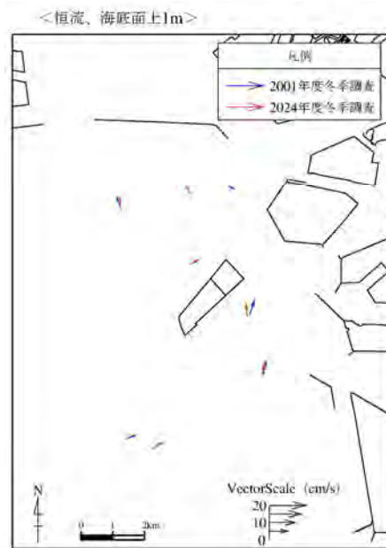
図 6-1. 6(2) 2-1 区護岸概成時と事業着手直後の海水の流れの違い(恒流：冬季調査、夏季調査)
