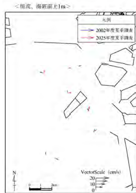
図 6-1. 6(2) 2-1 区護岸概成時と事業着手直後の海水の流れの違い(恒流：冬季調査、夏季調査)
