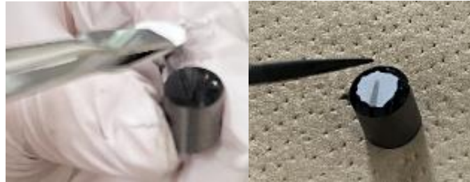
試料台にカーボンペーストで フィルタを接着
