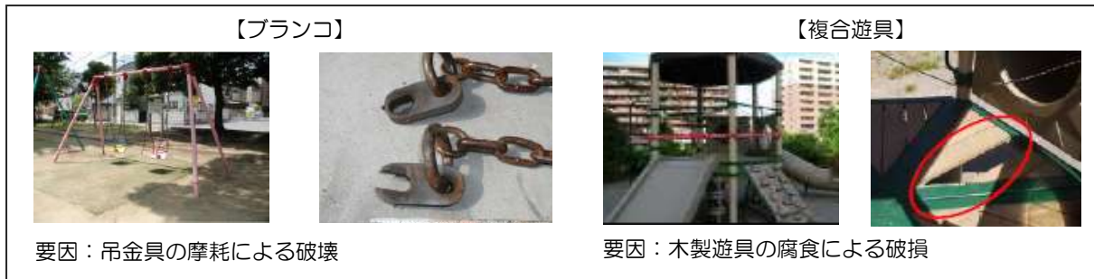
写真4.4-1 遊具の事故事例
