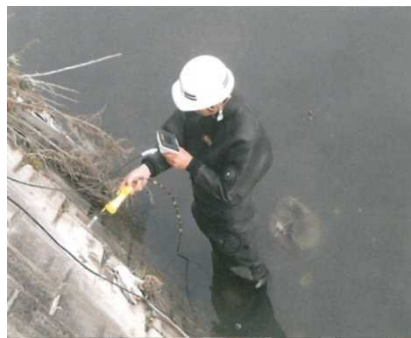
図 3.1-10 コアボーリング、カメラによる空洞化調査
