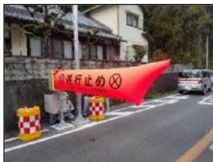
空気式遮断機による通行規制
