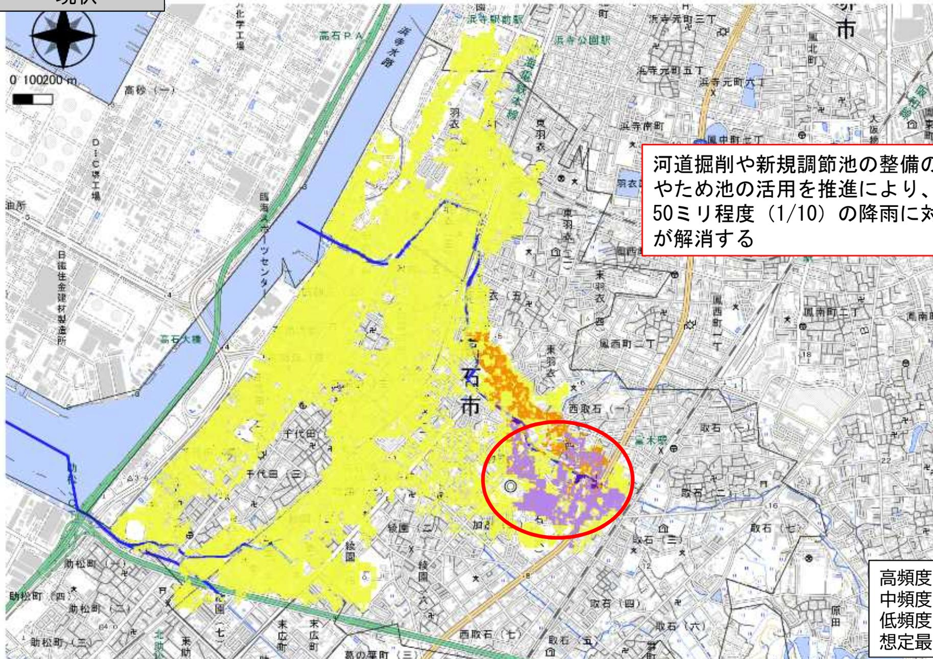
河道掘削や新規調節池の整備のほか、既存調節池やため池の活用を推進により、芦田川：時間雨量50ミリ程度（1/10）の降雨に対し、家屋床上浸水が解消する
