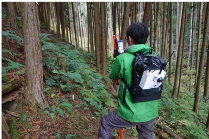
小型バックパック型LiDARを用いた立木調査の様子
