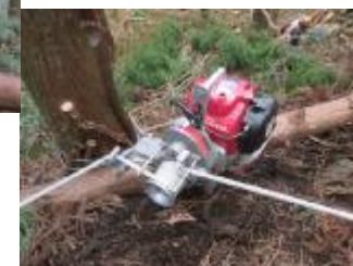
【ポータブルウィンチを使用した搬出作業】
