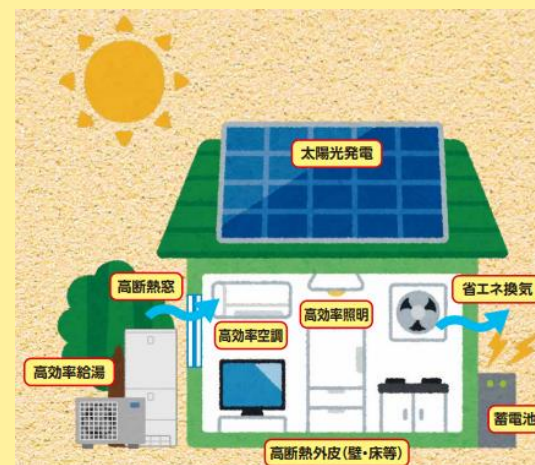
太陽光発電、省エネ機器、蓄電池等を活用したネット・ゼロ・エネルギー・ハウス（例）
