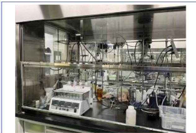
ドラフトを使用した実験室での作業時、作業者は操作性を優先してしまい、サッシを全開にして使用してしまうため、適切な風速が保つことができず、作業者が化学物質を暴露する危険性があった。
