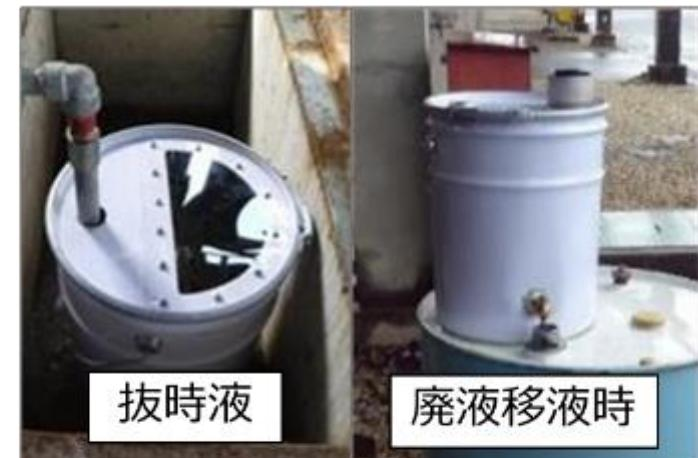
ペール缶に目視確認ができる窓が付いた蓋を設置し、ほぼ密閉系で液プローが可能となった。また、ペール缶にコック付きノズルを取り付け、発生源から距離を取りながら移液が可能となった。
