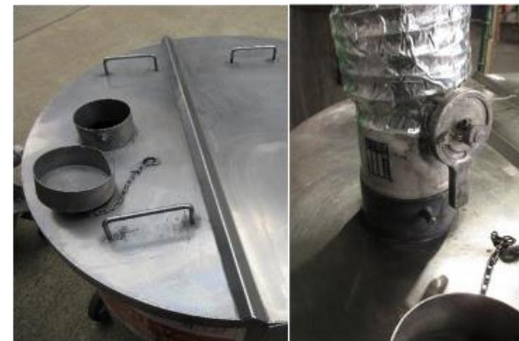
割蓋に局部排気ダクトの装着口を設けて、直接局部排気ダクトを差し込める構造とした。
