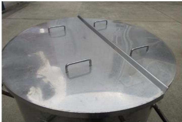
塗料製造の際に使用する移動タンクの割蓋に局部排気を装着する所がなく、局部排気を使用する際は蓋を開けた状態で使用していたため、溶剤が揮発し作業場に拡散していた。
