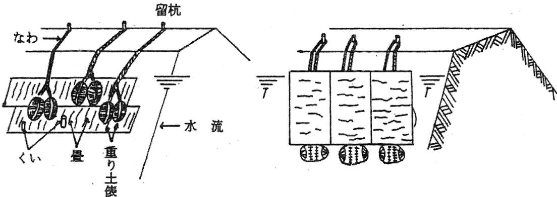
なお、下部土俵は別のなわで各土俵の左右2箇所を縛り、そのなわの端を力竹に結びつける。むしろの継ぎ合わせは竹針または鉄製針で縫い合わせる。竹は裏竹をそいで穴をあけ二子なわを通す。むしろを掛けおろすには、普通むしろおよび土俵などをすの子巻きとし、別のなわまたは鉄線をすの子巻きにしたむしろに巻きつける。なわの一方をゆるめながら漸次掛けおろして所定の位置におろすと、裏のりに打込んだ留ぐいに下端の重し土俵と力竹とを連結してなわを結びつける。
