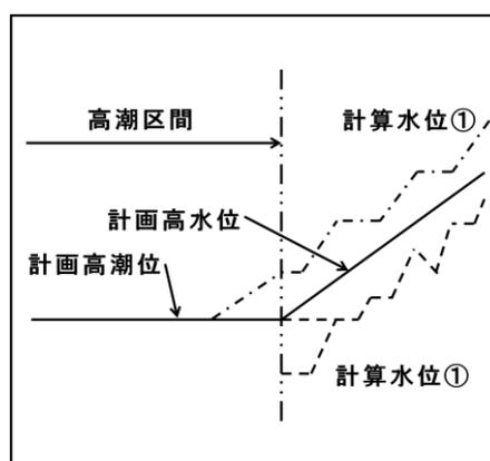
計算水位が現況の堤防高を越える箇所を A ランク、現況の堤防高までの余裕高が該当地点における堤防の計画上の余裕高に満たない箇所を B ランクとすることを基本とするが、堤防の構造、背後地の状況等を勘案し定めるものとする。例えば背後地の地盤高が高い場合など、家屋の浸水被害が発生するおそれが小さい場合などは、A ランクとしないことが考えられる。
