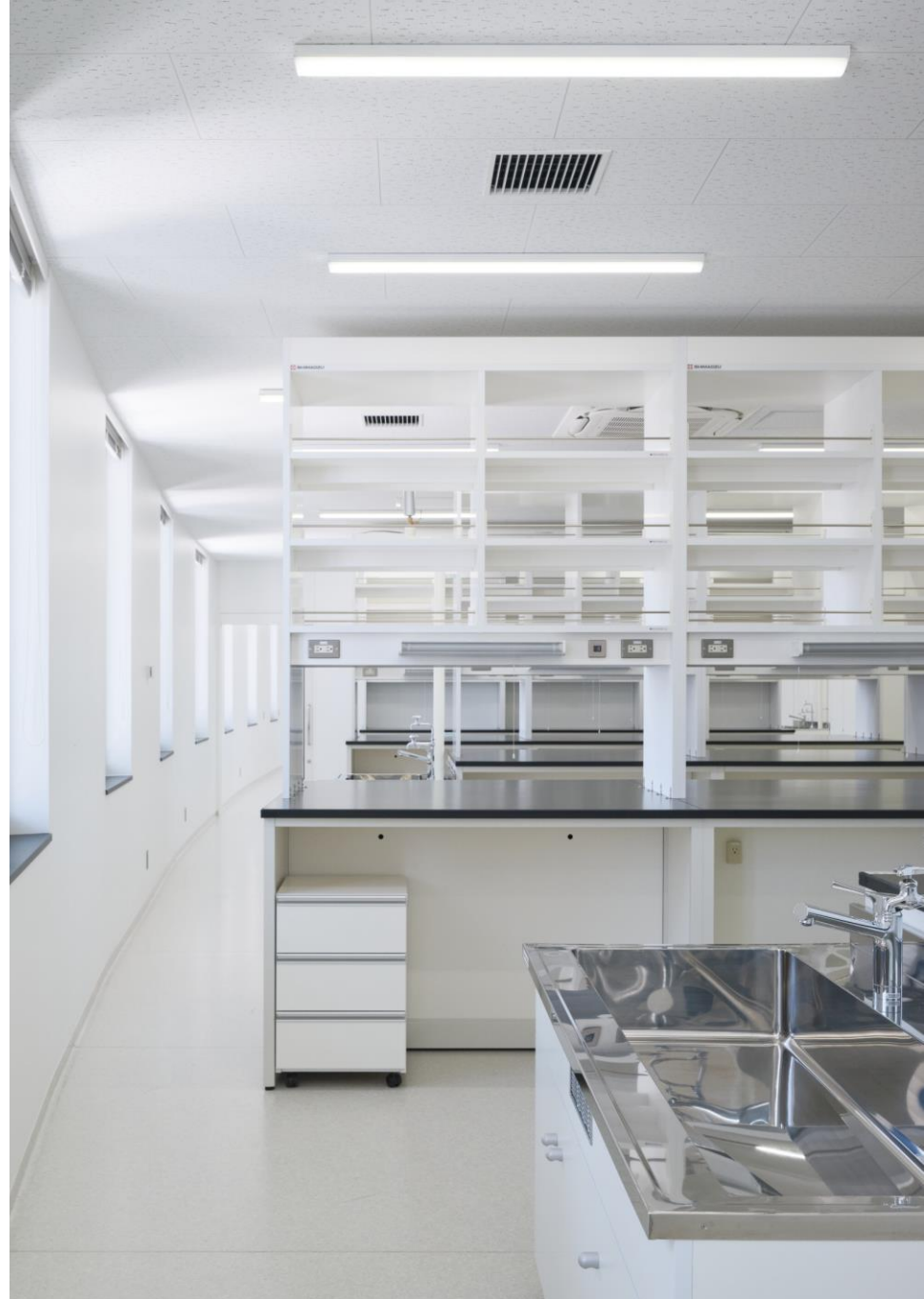
梁型を無くし、天井内の設備の自由度を高める
