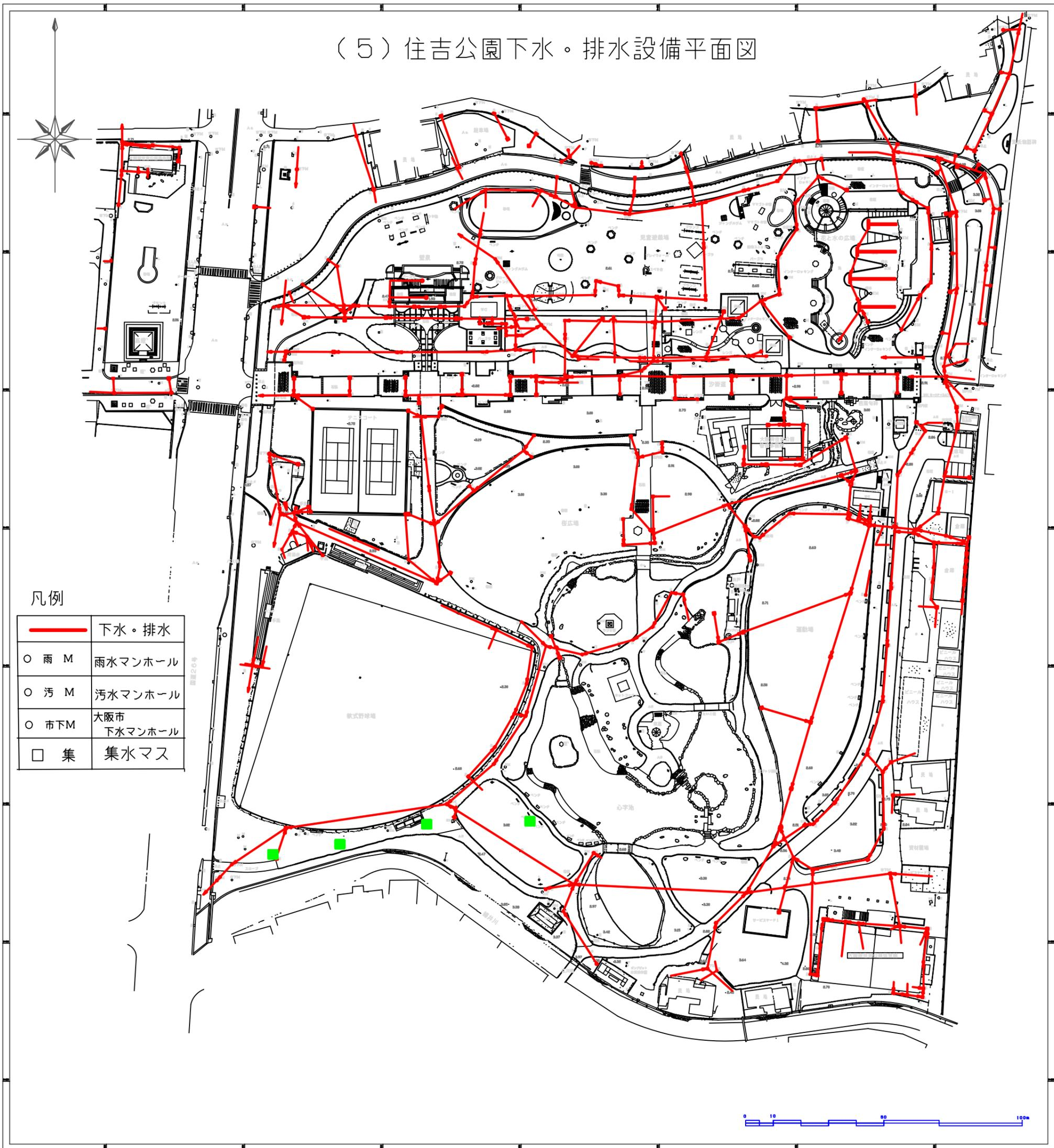
【図面11-10】 下水・排水平面図
