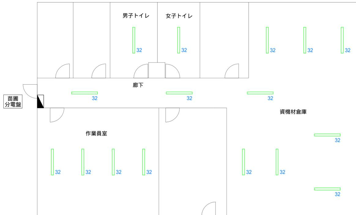
【図面11-09-10】 電気設備位置図(照明関係)
