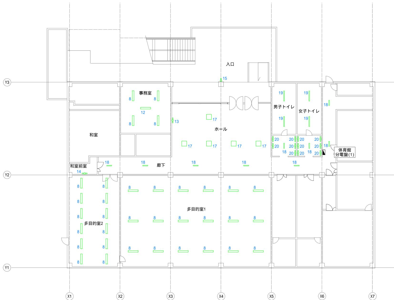
【図面11-09-8】 電気設備位置図(照明関係)
