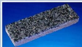
海藻着生阻害要因である浮泥の払拭を促進するプレート構造、かつ、海藻類の生長を促進する鉄やケイ素を溶出する「イオンカルチャープレート」を300枚設置し、藻場創出に取り組む。
