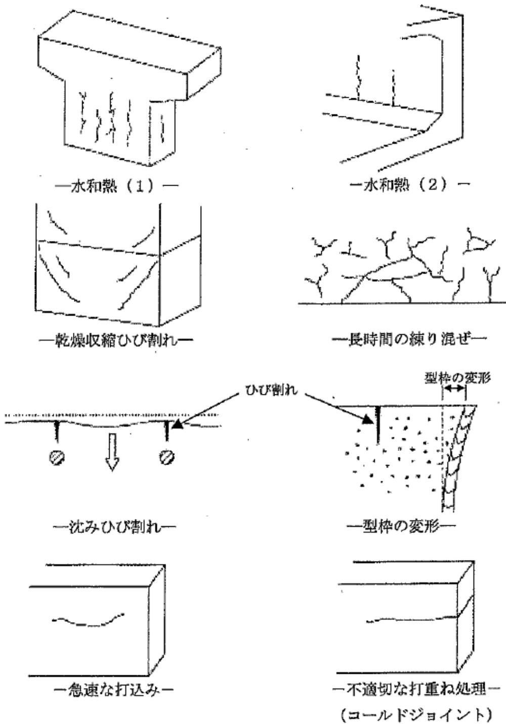
図-1 施工時に発生する初期欠陥の例
