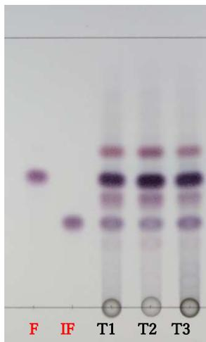
標準溶液及び試験溶液の TLC クロマトグラム (例)
