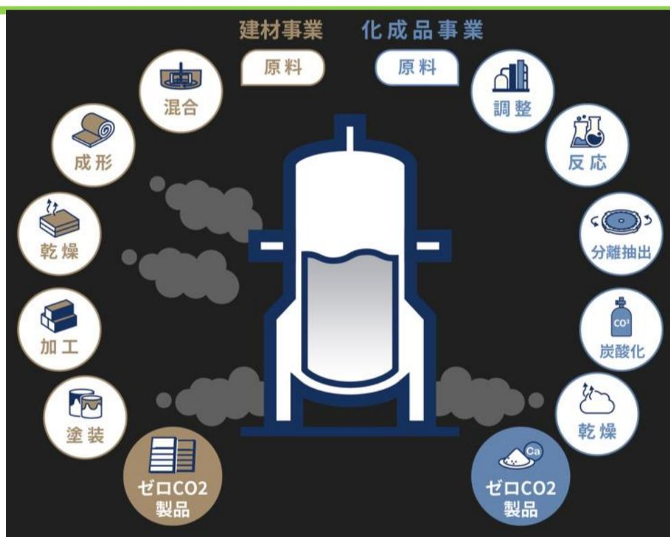
製造工程からの排ガスCO2を回収、アルカリ廃棄物と反応させ生成された炭酸化合物を建材の原材料として利用するCO2リサイクル製造プロセス。長年の研究開発で培われた炭酸化合物の「粒形・粒径コントロール技術」がこの当社独自の取り組みを支えています。2026年より製品を順次CO2固定化建材に切替、2030年には工場製造時CO2排出ゼロを目指します！
