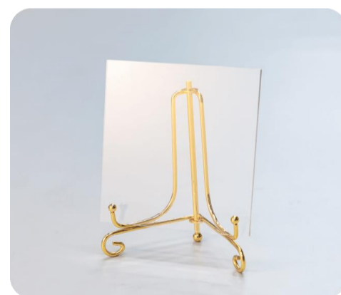
再生 MMA を原料に 作成した PMMA 板
