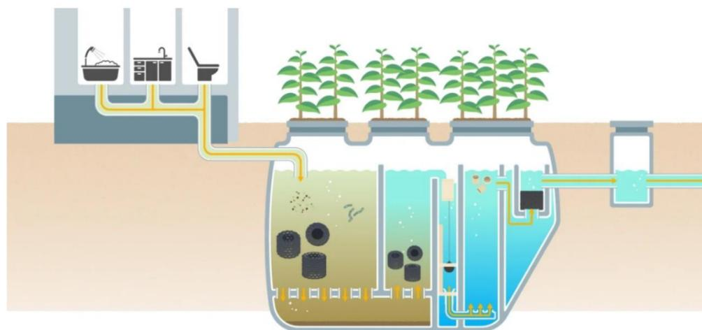
生活雑排水を電気をいらず、嫌気性の微生物の働きを最大限に引き出すことで水を浄化します。また、汚泥は堆肥化して肥料に、処理水は灌漑用水として利用することで、作物の生育を促進します。
