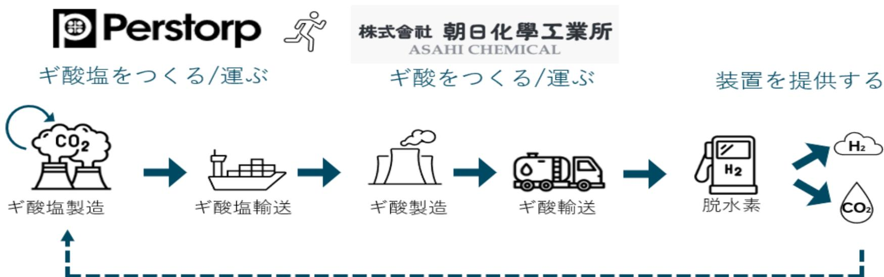
ギ酸は新しい水素キャリアとして世界中から注目を集めています。圧縮機を使わず、大きなエネルギー使わずに運べ、保管でき、脱水素ができます。また同時にCO2も出てきますが、液体として分離し、再利用が可能です。
