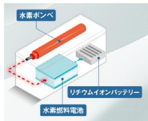
Hydroftyは、燃料電池（水素発電）と蓄電池を組み合わせた可搬型エネルギーシステムです。災害時には、外部電源が途絶えても水素燃料電池が起動し、速やかに電力を供給。避難所などの拠点において、照明、情報通信機器、医療機器などの電力需要を支え、安全・安心な避難生活をサポートします。
