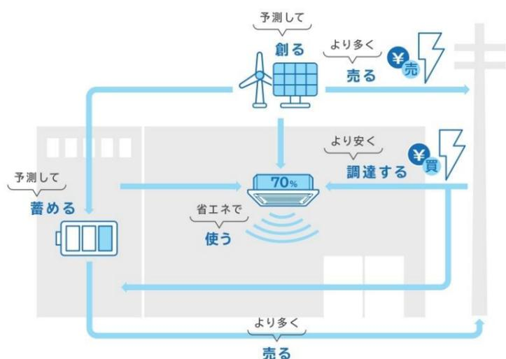
「SMART GRID MANAGEMENT (スマートグリッドマネジメント)」は、気象情報と連動したAIが電力市場取引(JEPX)の情報を参照し、最適化された電力の運用を行うシステムです。
