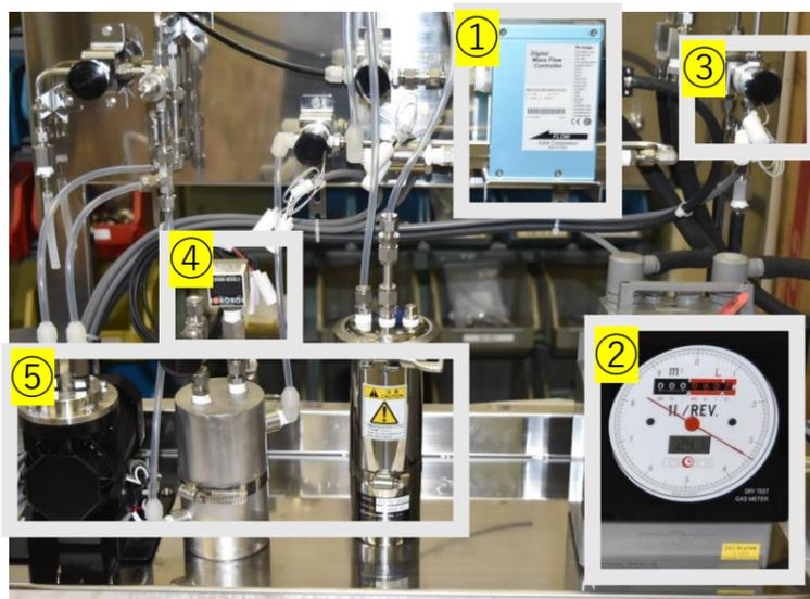
マスフロー制御、流路制御、データの取得を行います。
