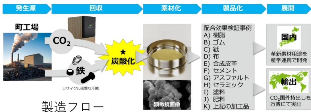
金属を新たに原材料にすることで、その約4割がCO<sub>2</sub>でできた機能性素材の量産プロセスを世界で初めて開発。CO<sub>2</sub>の高付加価値用途の不足問題を解決し、CO<sub>2</sub>を活用しながら発展する社会を目指します。
