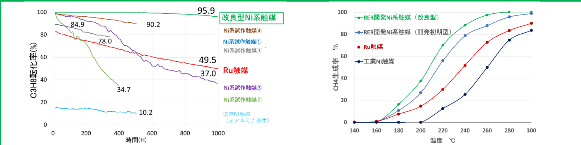
高性能水素製造用水蒸気改質触媒の連続評価結果およびメタン化触媒の温度依存性
