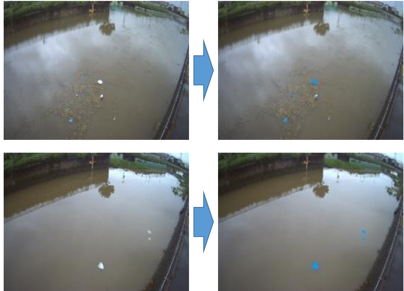
元画像（左）とAIによりごみと判別された部分を色付けした画像（右） （地点：恩智川中流（カメラ設置箇所：恩智川治水緑地））
