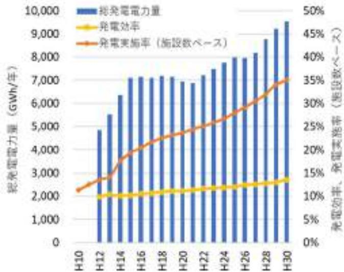
発電電力量と発電実施率、発電効率
