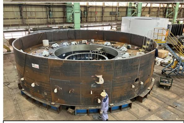
鶴見調節池のシールド機【製作中】外径φ10m
