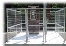
写真 4.2-1 フロベラ式湖水循環装置 (出典：パンフレット)
