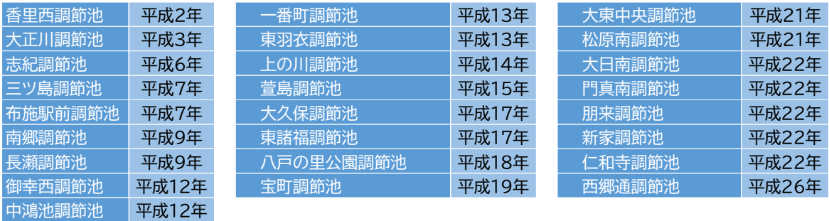
図 3.2-3 地下調節池の施工年度と施工数
