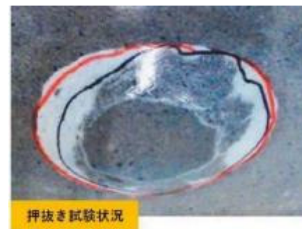
図 3.9-26 品質向上：剥落防止（透明・冬季施工可能）
