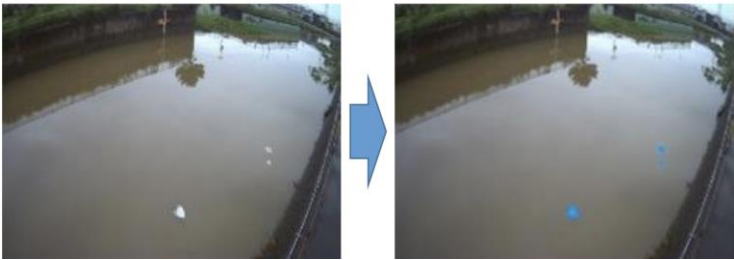
AIによるごみの判別 （左：元画像、右：AIによる色付け） （地点：恩智川中流（カメラ設置箇所：恩智川治水緑地））
